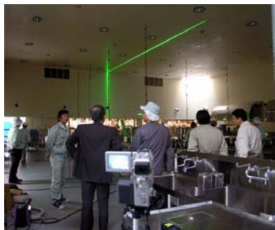
レーザーや測定機器を使って細かく調整しています
